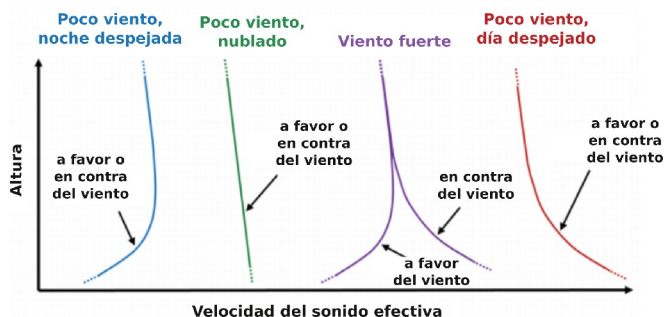
Figura 2.6: Perfiles característicos de velocidad del sonido efectiva para cuatro casos límite de la CLA. Los perfiles se desplazan arbitrariamente a lo largo del eje horizontal para mejorar la visibilidad. Adaptado de Wilson et al. (2015).
