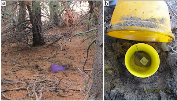
Figura 5.2: Ejemplo de instalación de un sensor en CPH. a) Sensor parcialmente cubierto, en este caso con rocas, pinocha y ramas. b) Detalle del contenedor (balde de 20 l). La tapa del balde se coloca de forma tal que no ingrese agua pero que el cierre no sea hermético. Por encima se coloca la cubierta externa (fuentón).
